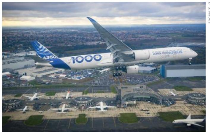
Der Airbus A350 XWB in Hochauftriebs-Konfiguration
